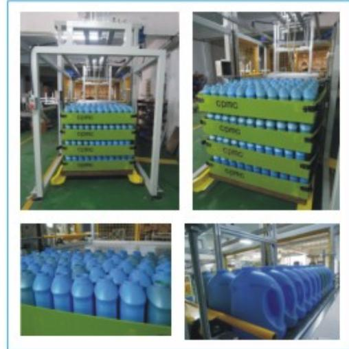
本机适用于纸托式瓶子打包，瓶子通过入料输送带送入本机中，通过机台的计数，排瓶瓶装已排列好的瓶子推入托盘中（托盘需手动放入），只需一人通过简单的操作即可对瓶子进行堆垛，相比手工堆垛可大大降低工人劳动强度及人员数量。
