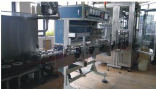
农药瓶测漏灌装连线
