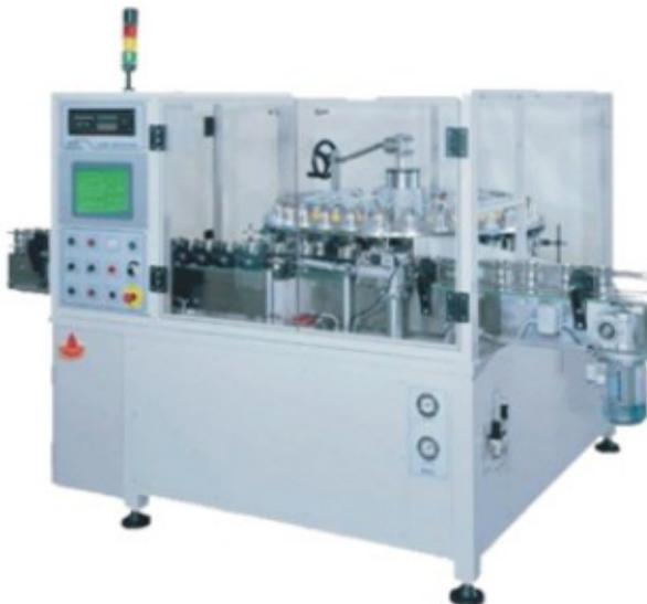
该型号是在引进国外先进测漏技术和加工工艺的基础上研发的高速旋转式多工位测漏机。全线采用CNC数控加工技术、机械系统结构优化设计，精密度高，科技含量高，完全满足高速在线运行要求的可靠性和稳定性。最高速度达36000瓶/小时
