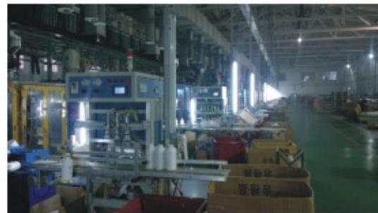
农药瓶吹瓶测漏连线
